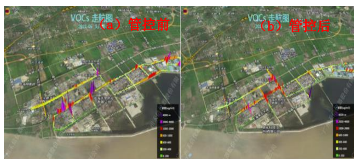
图 1 管控前、后的走航路线以及 \Sigma VOCs 排放浓度的空间分布情况示意图
